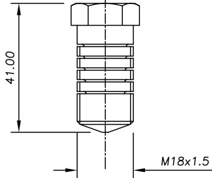
M18 Conductor Clamping Bolt
