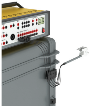
2.2 Schließen Sie die ESSAILEC® Prüfsteckerkabel an das Prüfgerät an.
