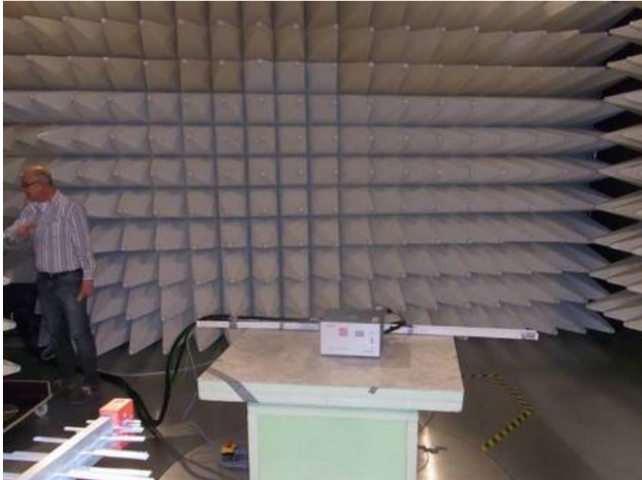
Foto 2: Störfestigkeit gegen HF-Einstrahlung, 80-1000MHz, horizontal, Frontseite
