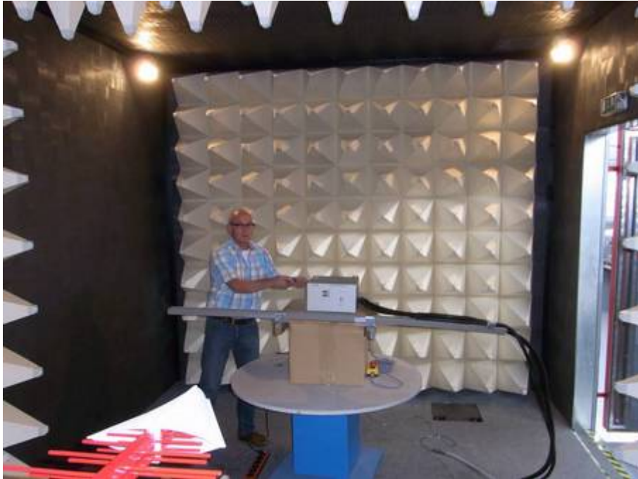
Foto 12: Gestrahlte Störaussendung (Funkstörfeldstärke), 30-1000MHz, horizontal, Frontseite
