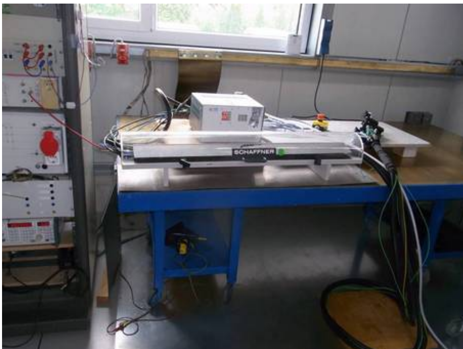
Foto 7: Störfestigkeit gegen schnelle Transienten (Burst), Last- und Steuerleitung (Heizleitung, Thermoelement,
