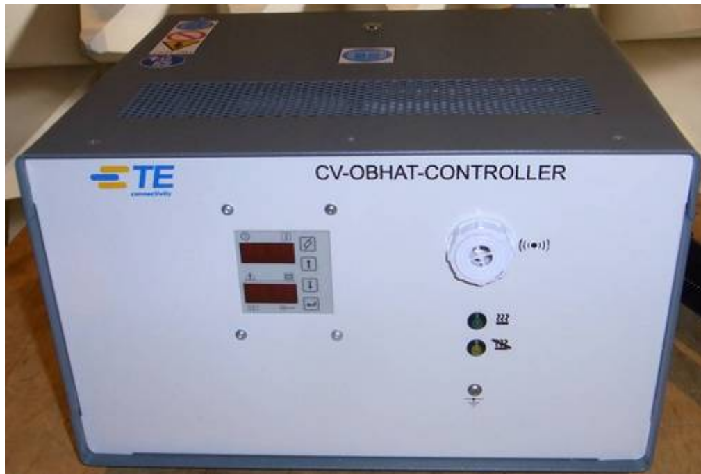
Foto 1: Schrumpfschlauchbearbeitung, CV-OBHAT-Controller (EUT)
