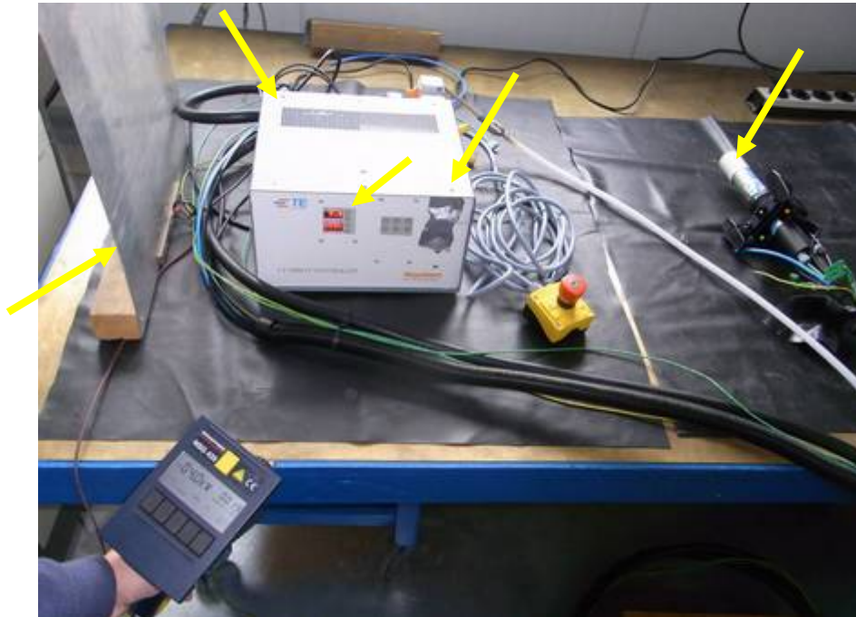
Foto 9: Störfestigkeit gegen elektrostatische Entladung (ESD), Kontaktentladung
