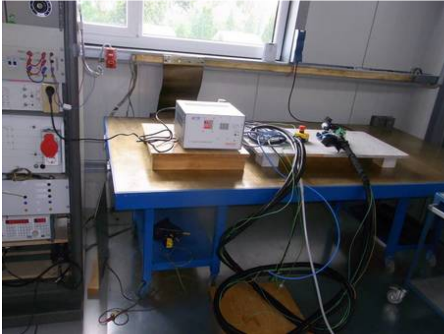
Foto 6: Störfestigkeit gegen schnelle Transienten (Burst), Netzleitung 230V
