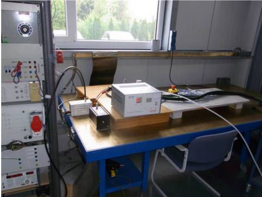
Foto 4: Störfestigkeit gegen HF-Einkopplung auf Leitungen, 150kHz-80MHz, Netzleitung 230V
