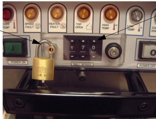
Obr. 1.2: Blokování rychlosti pásu u stroje Model 19SS
