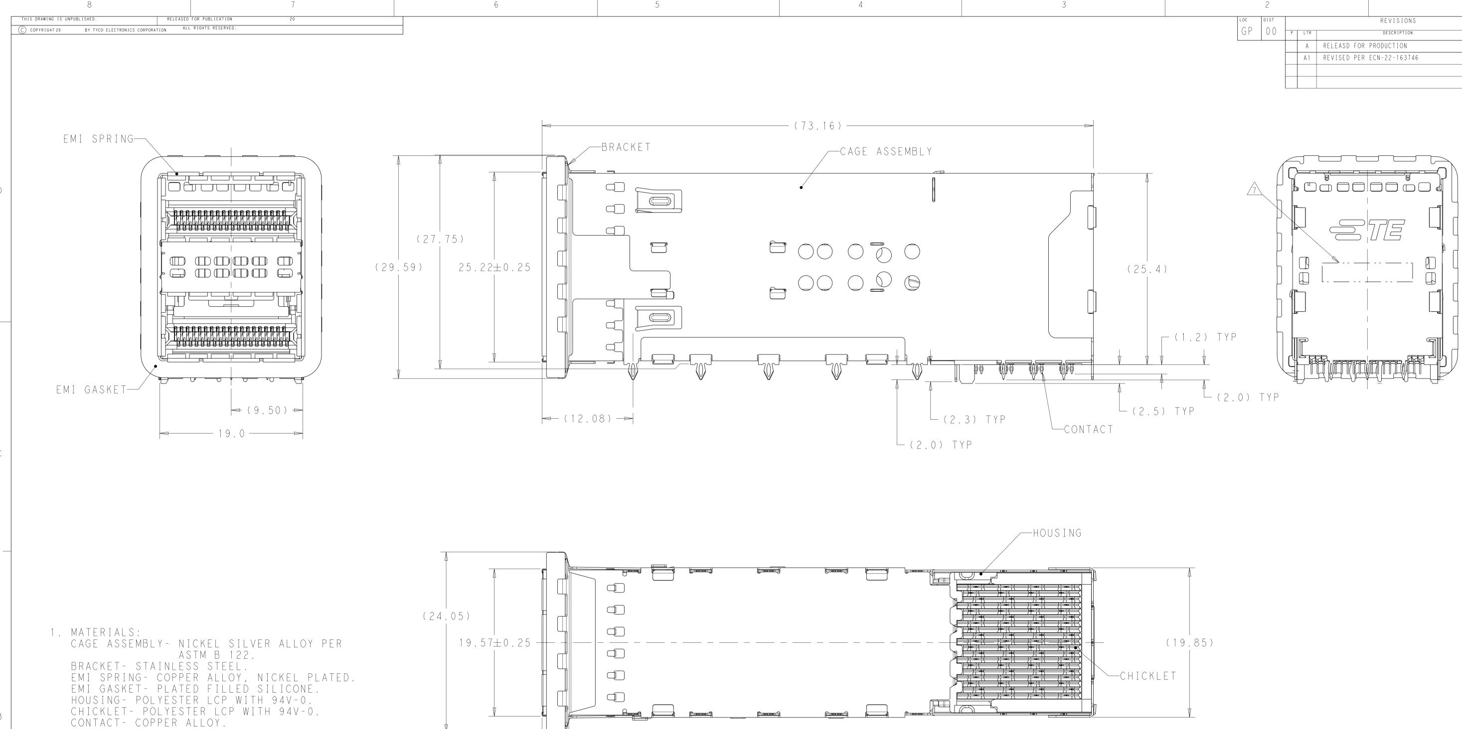
CONTACT FINISH: 0.76μm GOLD ON MATING END, 1.25μm MATT TIN ON SOLDER TAIL, ALL OVER 1.27µm NICKEL.
