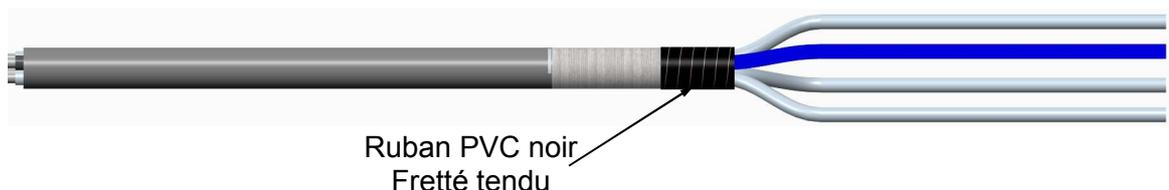
**Important:** Afin de ne pas endommager les constituants des câbles synthétiques (isolant des conducteurs et gaine externe), il est **INTERDIT DE CHAUFFER LES CABLES** lors de la confection des accessoires souterrains
