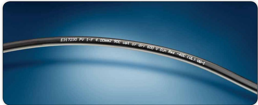
作为对SOLARLOK产品系列的扩展, TE生产出旨在满足典型光伏装置所在的苛刻环境条件的电缆。这些交联电缆使用灵活, 套有双层绝缘护套, 不含卤素, 通过了TÜV和UL认证, 从而能提供长期的稳定性。其突出特点包括: 能抵抗如潮湿、紫外线辐射和臭氧等环境条件。此外, 它们还具有优良的耐磨损性能, 能在极端温度条件下工作。由于采用了细绞合镀锡铜导体, 这些电缆具有高介电耐压性能, 很容易处理、弯曲、排线和剥线。
