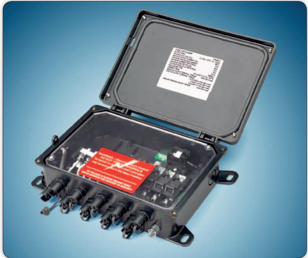
L'ensemble coffret de jonction SOLARLOK est utilisé pour combiner jusqu'à cinq rangées dans un coffret pré-serti muni de connecteurs, résistant aux intempéries, comme l'exige la norme NEC ( National Electric Code ) pour le regroupement en série de modules photovoltaïques ( PV ) ( panneaux solaires ).
