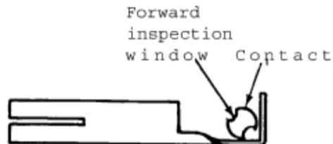
MINI SOLDER SLEEVE REFLECTOR FOR AA-400 SUPERHEATER
